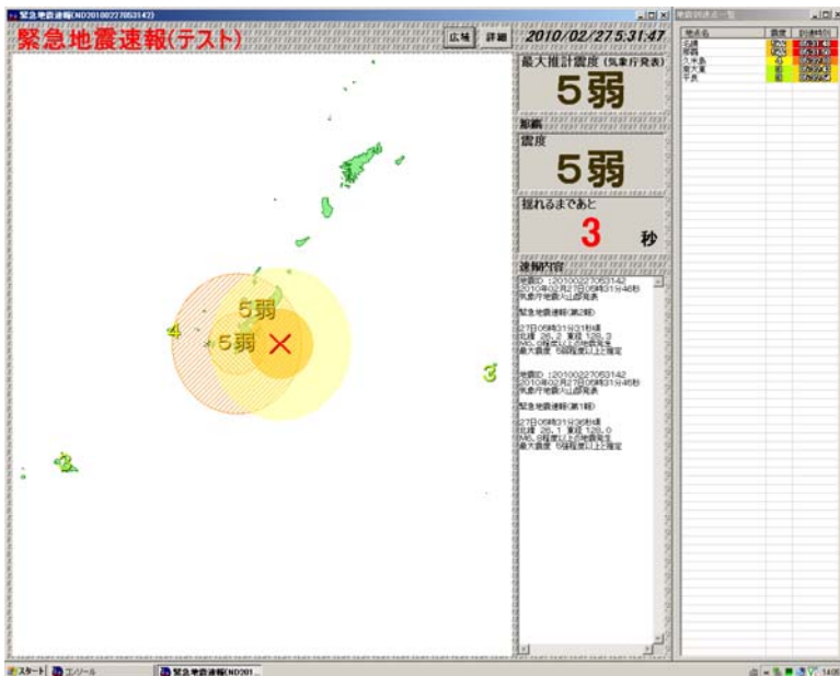
図1 一般向け緊急地震速報（警報）受信直後の那覇市に着目したときの「なまずきん」による再現表示。×印が震央、外側の円（薄い黄色）がP波、内側の円（橙色）がS波（主要動）の拡がり。沖縄県本島中南部及び沖縄県本島北部で震度5弱が予測されています。那覇市を中心とした2つの円は、P波（外側）とS波（内側）の距離限界円。距離限界とは、緊急地震速報よりも地震波の方が早く到達すると推定される距離の限界のことです。
