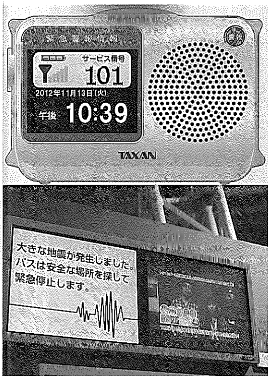
V-LOWマルチメディア放送防災機器。上は同放 送で使われる専用の防災ラジオ。下は街中や防災 行政無線などに取り付けて、防災情報を流すデ ジタルサイネージ
